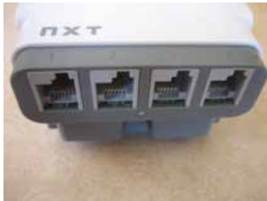
Les ports d'entrées (capteurs)
